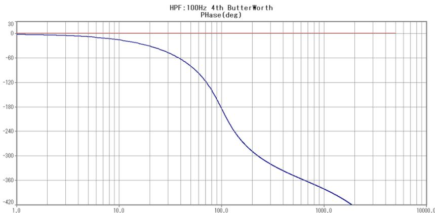
青色表示が LPF 処理結果、赤色表示が HPF と HPR の 2 回処理結果を示します。位相特性はローパスフィルタと同じになります。
