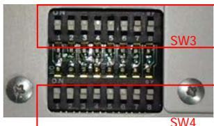
信号入力コネクタ部を手前方向としてカバーを外すと左図のように、上下 2 つのディップスイッチが見えます。上部のディップスイッチが SW3、下部のディップスイッチが SW4 となります。
