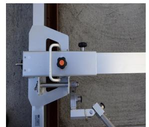
組立は、検測梁に軌間梁を差し込んでダイヤル固定するだけ
