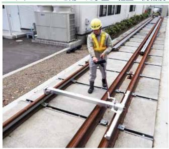
LR-S100 は、1.25 m検測梁上のジャイロセンサが検 知する軌道形状成分を演算処理して 2.5 m弦を測定す る新しい軌道検測法 \* を採用しています。これにより、 装置の小型・軽量化と高精度化を実現しました。
